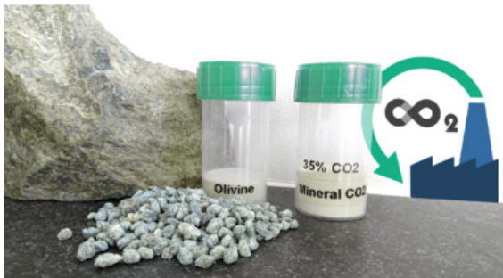
← Green Minerals bruker jomfruelig olivin. → Det produseres magnesiumkarbonat som fyllstoffer.
